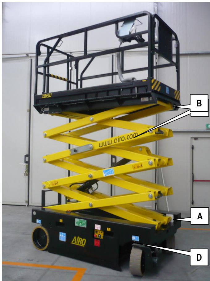
7-5: Plaats van de belangrijkste te smeren onderdelen
