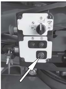
Fig. 145 Verklipper toestemming hoogwerkerdeel noodbedieningspaneel
