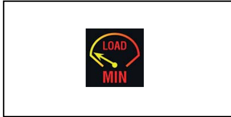
Fig. 134 Alarm stijging hoogwerkerbak
