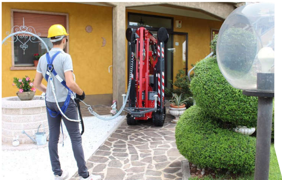
Les dimensions réduites permettent à la machine d'accéder à des espaces étroits comme les jardins et les cours.
