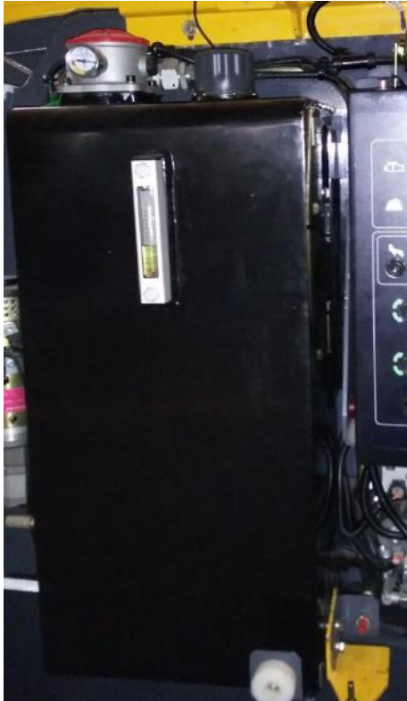
Afbeelding 6-2 Indicator hydrauliekoliepeil en temperatuur in de hydrauliekolietank
