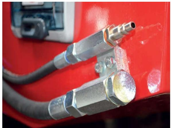
**Ligne auxiliaire Ø1/4"** dans le panier standard pour permettre l'utilisation de différents outils, par exemple, à air.
