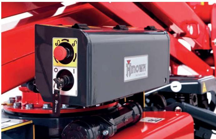
**Position pour commandes d'urgence de la partie aérienne et avec clé de fermeture pour garantir la maximale sécurité.**
