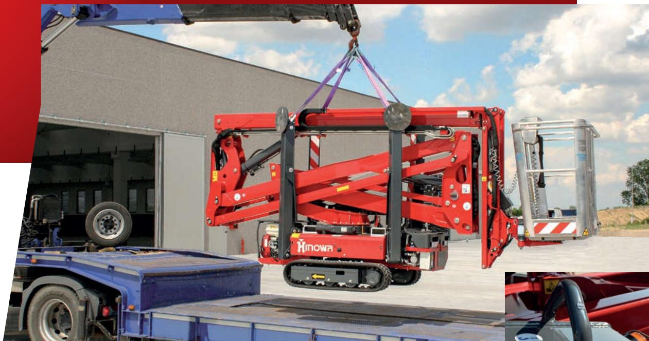
**Crochets de levage** sur les stabilisateurs
