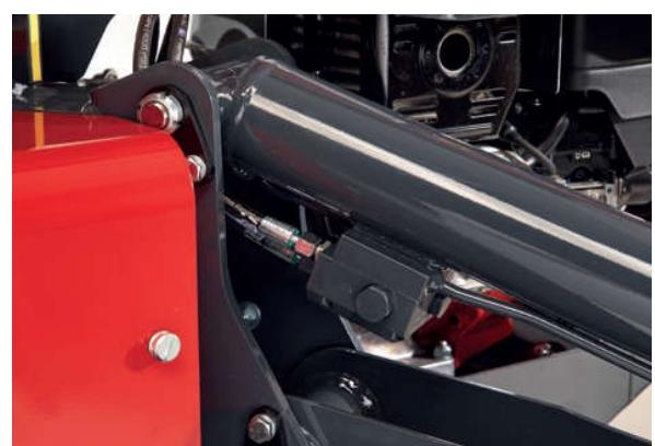
**Doubles clapets de sécurité** sur stabilisateurs avec protection de l'ensemble.
